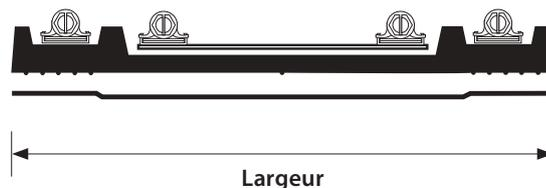
Nos raccords sont fabriqués sur mesure. La plage d'utilisation de chaque type de raccord est d'environ de 20 mm. Au-delà de 620 mm, nous consulter pour connaître la dimension exacte de nos raccords fabriqués selon vos besoins.
