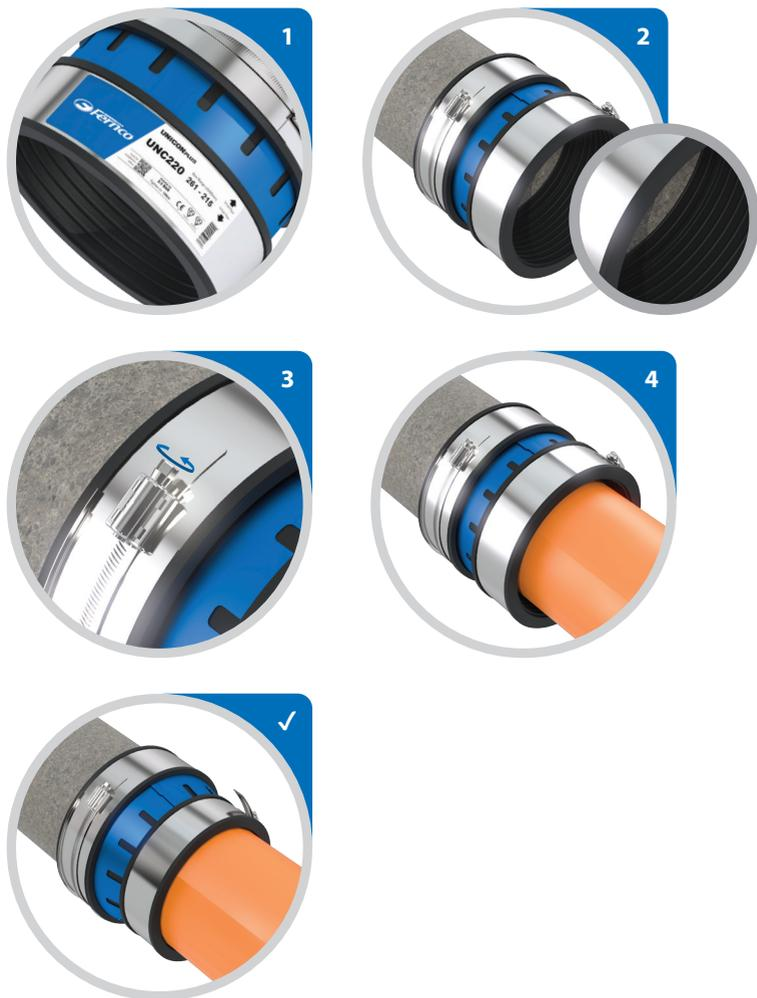
1. Choisissez le bon raccord Unicon : le diamètre extérieur de chacun des tubes à raccorder doit correspondre à la plage d'utilisation du raccord.
